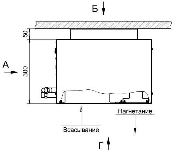
Рисунок 3 Габаритные и присоединительные размеры
